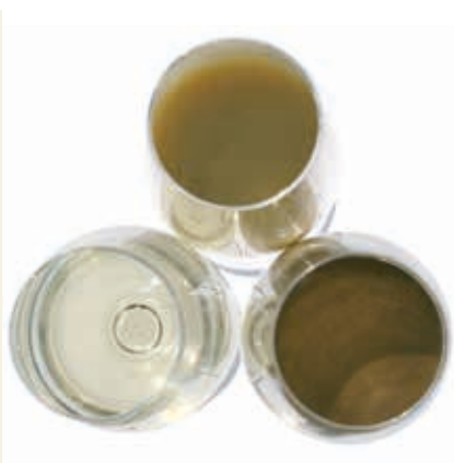
Bourbes avant filtration / Moût après filtration / Rétentat final
