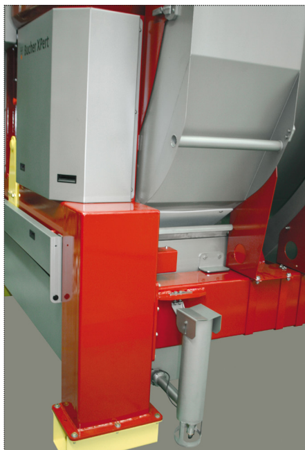
Maie "active" de réception des jus avec son puits de mesure (externe).
