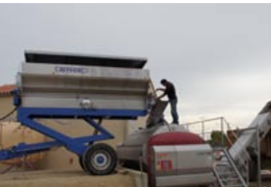
L'installation de traitement de la vendange complète avec une benne élévatrice en cours de déchargement.
